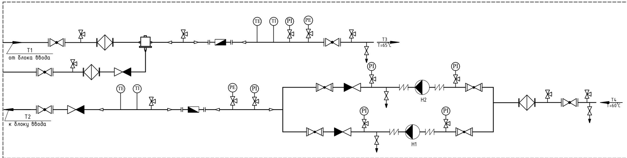
Рисунок 1 - Принципиальная схема блока "МЦЭ-БТПА-ГВС"
